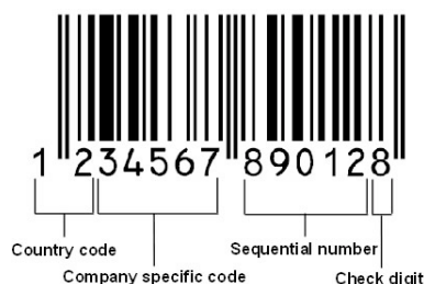
Εικόνα 1: Συμβολισμός EAN-13 barcode. Figure 1: Symbolism of EAN-13 barcode.
